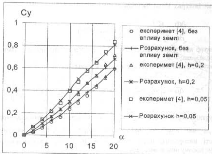
Рис. 2. Залежність коефіцієнта підйомної сили від кута атаки
