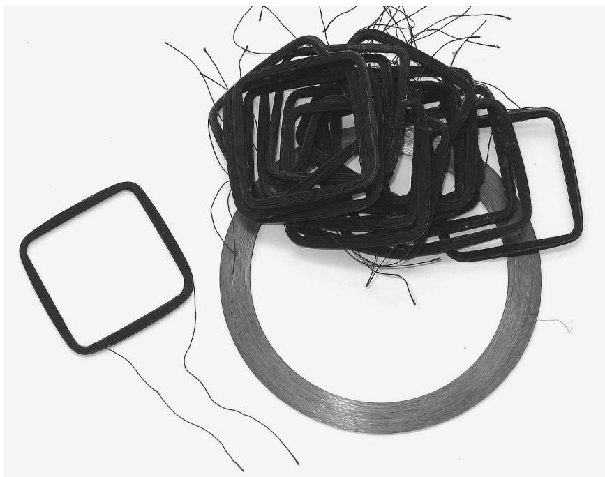
Рис.4. Катушки низкочастотных и высокочастотных трансформаторов, изготовленные с помощью автоматизированной системы управления.
