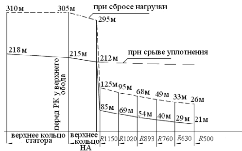
Рис. 3. Эюра распределения давлений под крышкой турбины в турбинном режиме
