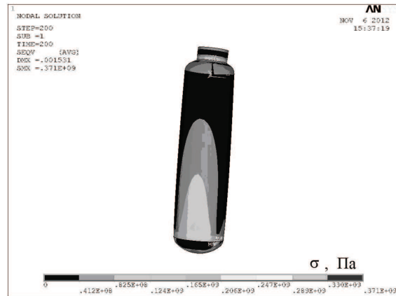
Рис.4. Эквивалентные напряжения по Мизесу
