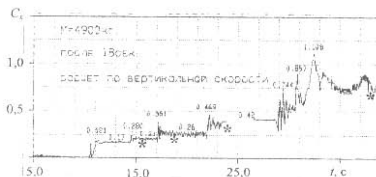
Рис. 7. Расчетные (кривая) и экспериментальные (звездочки) коэффициенты сопротивления трехкупольной парашютной системы
