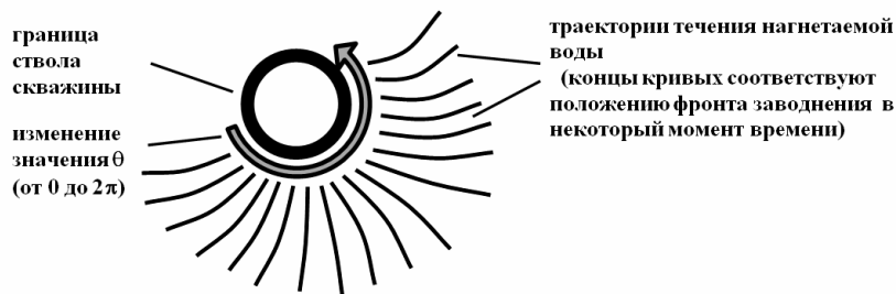
Рис.4.1. Схема построения границы ВНК путем объединения нескольких трассеров: каждая траектория течения соответствует решению одной задачи Коши (4.1).
